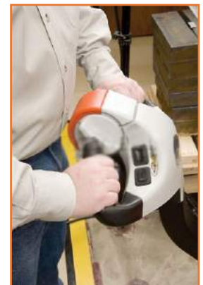
Bouton ventral à auto-renversement pour protéger l'opérateur lors d'utilisation dans des endroits étroits
