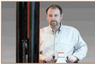
Mât étroit décentré offrant à l'utilisateur une vue sans obstruction et point mort.
