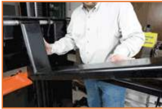
Fourches ajustables sur le chariot du mât pour un repositionnement rapide pour accommoder différents types de charges.
